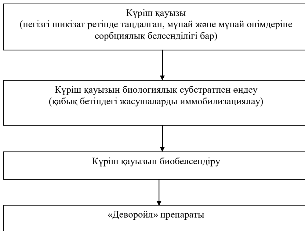
5 Сурет – Биопрепаратты өндірудің принципіалдық сызбасы
